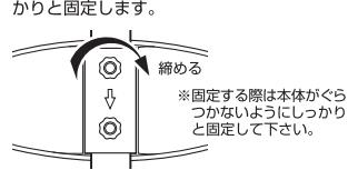
⑥本体底面にある4つの穴に付属のベルトハンガーを差し込み、CLOSEの方向に止まるまでしっかりと時計回りに回します。
