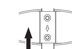
⑤固定ネジを時計回りに回し、本体と棒をしっかりと固定します。
