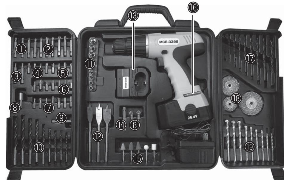
① **50mmマイナスドライバービット3本** ( 刃幅4mm・5mm・6mm )
