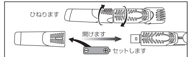
②電池ボックスのフタのツメと本体のミゾを合わせて差し込み、ひねってフタを元に戻します。※本体裏面の印が合う様に閉めて下さい。(下図参照)
