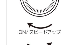
⑦ 電源スイッチを回して、速度を調節します。
