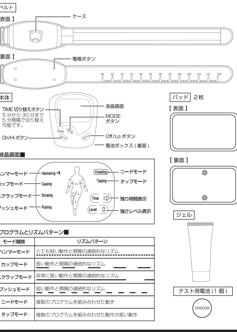
①ベルトの裏面の電極ボタンにパッドを取り付けます。
